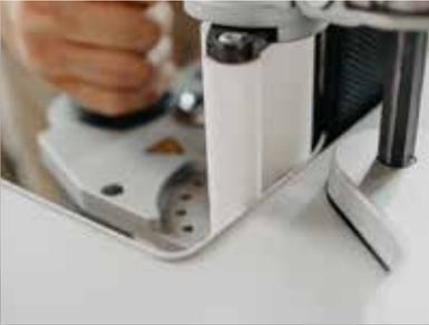
Speziell durch die angetriebene Andruckrolle der SA-Variante sind extreme Innenradien ab 10 mm mühelos umsetzbar.
