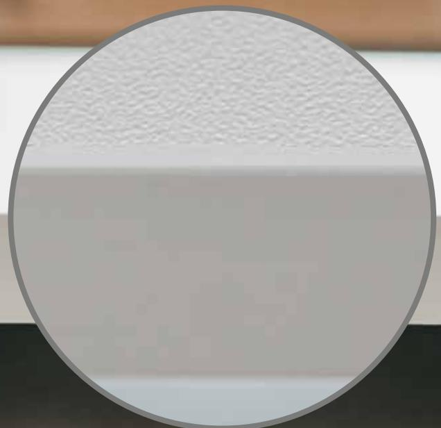
**Der HIT-M ist das erste und einzige mobile Gerät zur Erstellung einer optischen Nullfuge. Mit der Heißluft-Injektions-Technik lassen sich alle handelsüblichen Nullfugen-Kanten mit aufgetragener Funktionsschicht bearbeiten - ohne den Einsatz von zusätzlichem Kleber.**
