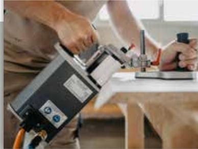
Das Bekanten schräger Flächen kann mit wenigen Handgriffen realisiert werden. Im mobilen Einsatz werden dabei bis zu 50°, mit der pneumatischer Winkereinstellung im Bearbeitungstisch 55° erreicht.
