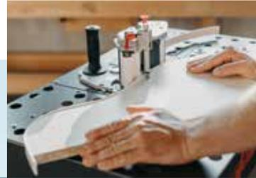
Individuelle und komplexe Freiformteile lassen sich ausgezeichnet mit dem HIT-M 65 SA inkl. angetriebener Transportrolle und dem Bearbeitungstisch BAT erstellen.
